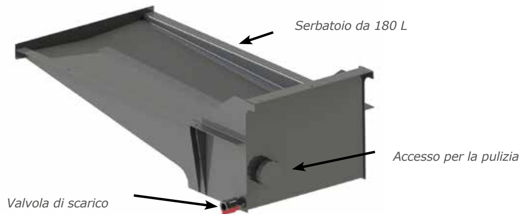
Piano mobile adatto ai rifiuti domestici, i liquidi vengono raccolti in un serbatoio sotto l'interasse del telaio
