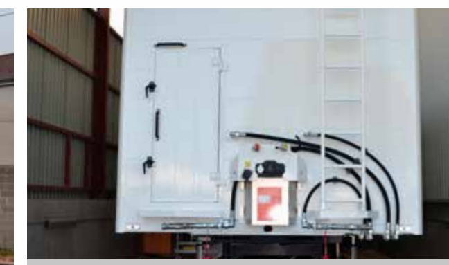
Sportello di accesso all'unità di trasmissione anteriore per manutenzione
