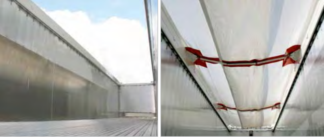
Zusätzliches Verschleißblech nach Maßvorgabe (3 oder 4 mm).
