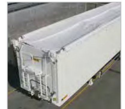
05 - Hydraulische Netzabdeckung Steuerung an den Stirnwand, vom Boden aus bedienbar.
