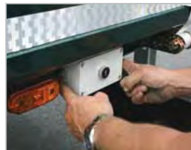
01 - Tasterbetätigung für zusätzl Sicherheit in Heckseitenrahmen.
