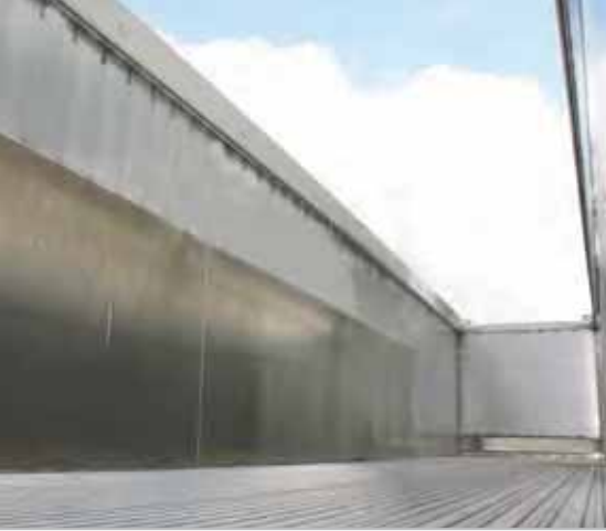
Doublage intérieur des parois en tôle aluminium 3 ou 4 mm.
