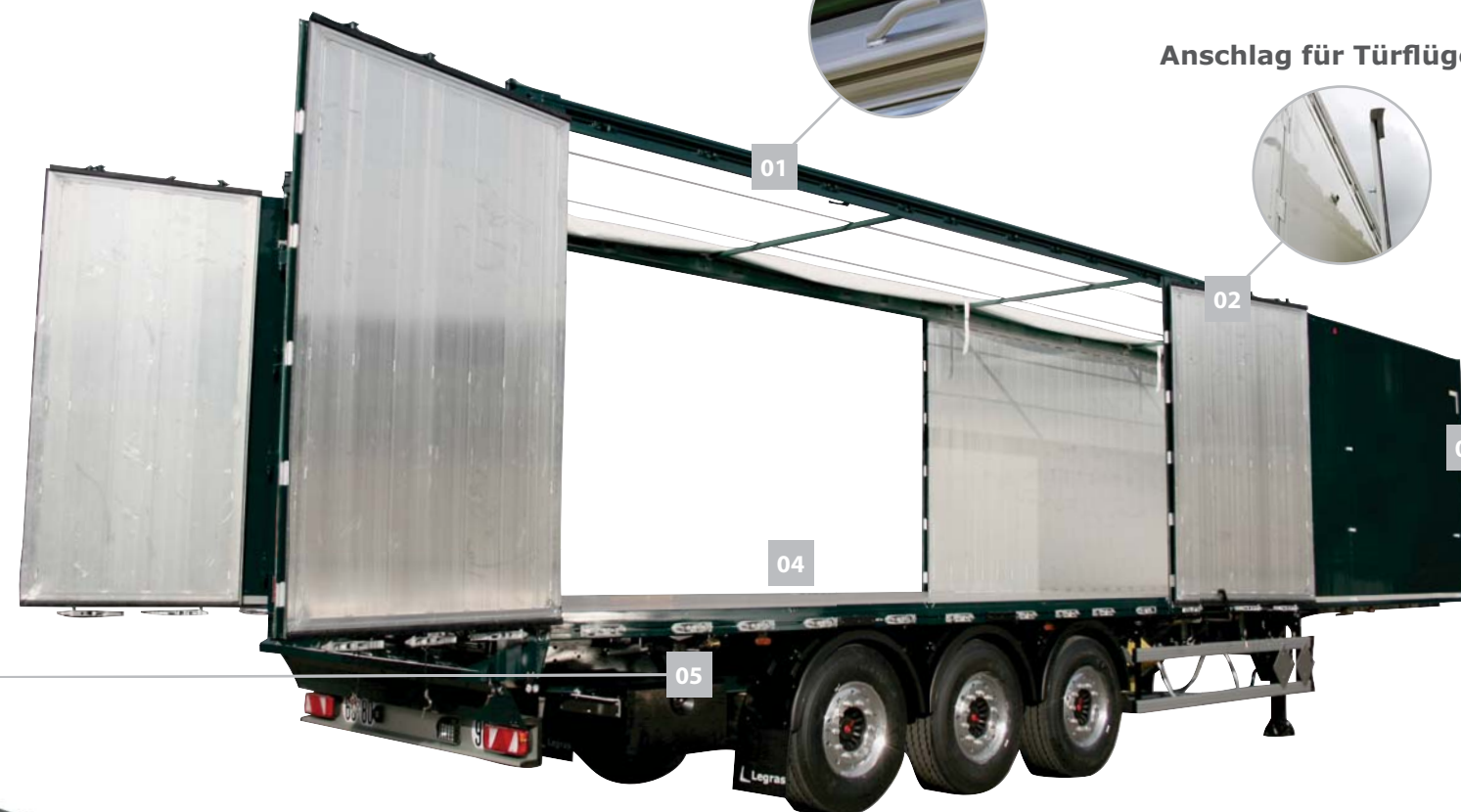
Dachrollplane und umklappbare Planenstopper mit Rückholfeder.
