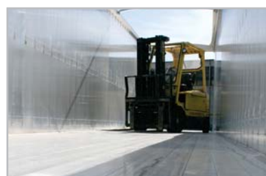
Boden befahrbar. Legras-Böden sind absolut Gabelstaplerbefahrbar bis 9 to.
