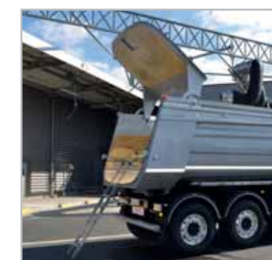
Accès intérieur de la benne sécurisé (verrouillage porte levée + arrimage de l'échelle).
