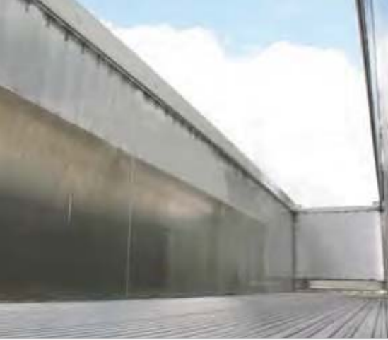
Zusätzliches Verschleißblech nach Maßvorgabe (3 oder 4 mm).
