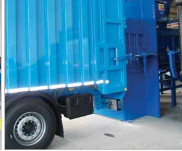
Accouplement du compacteur à la semi-remorque
