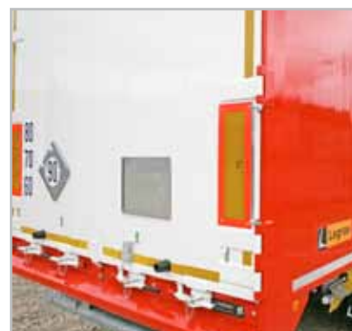
01 - Verstärkte Türen Profil mit 4 integrierten Verriegelung Ø 28.
